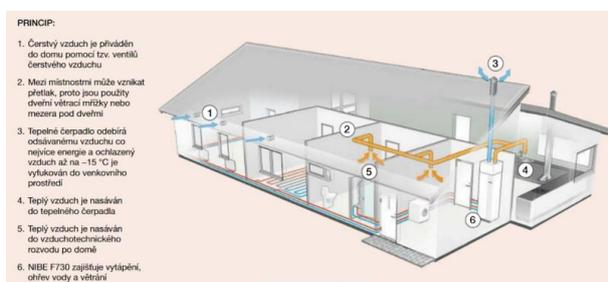
Všechny prvky nutné pro provoz ventilačního tepelného čerpadla NIBE S735 (včetně výkonově řízeného kompresoru, 180litrového zásobníku teplé vody, energeticky úsporného ventilátoru, oběhového čerpadla či doplňkového elektrokotle o výkonu 9 kW) se nacházejí v jediné kompaktní vnitřní jednotce, kterou lze jednoduše instalovat v interiéru. U tepelného čerpadla NIBE S735 tak není nutné řešit umístění venkovní jednotky (jako u typu systému vzduch-voda)
