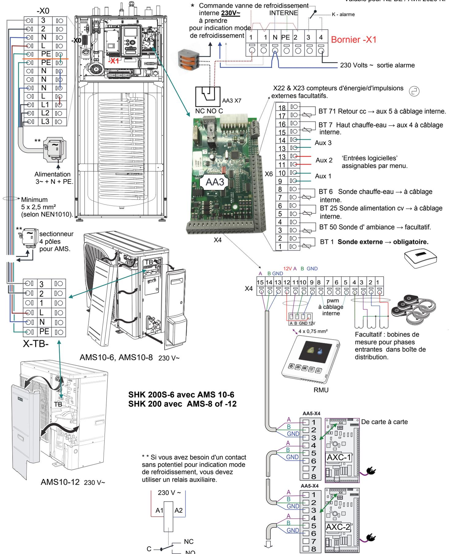
Selon la configuration hydraulique, une carte d'extension AXC peut être nécessaire par accessoire. Par exemple pour un 2e groupe de chauffage. Vous pouvez interconnecter les cartes en utilisant un câble de signal de 3 (ou 4) x 0,75 mm<sup>2</sup> (LiYY, EKKX), **de préférence blindé**.
