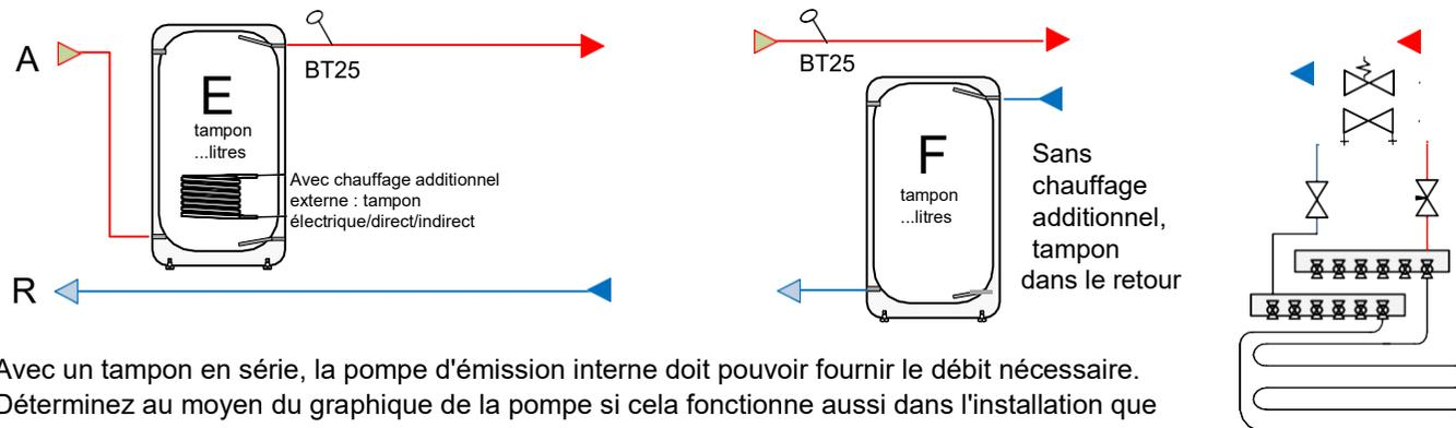
Avec un tampon en série, la pompe d'émission interne doit pouvoir fournir le débit nécessaire. Déterminez au moyen du graphique de la pompe si cela fonctionne aussi dans l'installation que vous avez conçue.
