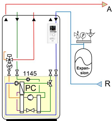
Pensez aussi à un capteur de départ BT25 ; si vous avez par exemple un schéma où le rafraîchissement passe à l'extérieur du tampon, un capteur BT-25B est parfois nécessaire. Vous pouvez alors, au moyen d'un relais auxiliaire, passer d'un capteur à l'autre pour que le bon capteur fonctionne dans un mode déterminé.
